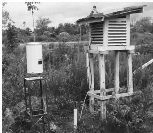
写真-5 インドネシア国カリマンタン泥炭地に設置した水位計と雨量計
